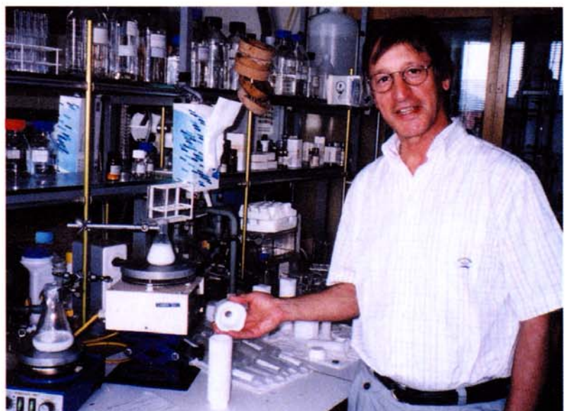
Gion Calzaferri zeigt das aus Teflon konstruierte Reaktionsgefäss für die Synthese von Zeolith L. (Foto: E. Heinzelmann)
